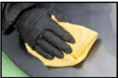
用洁净的 G 增强型擦布* FC-3 （3 块布），以圆周 运动方式轻轻擦磨 FC-100 （100 块布）
