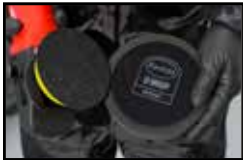
将 G Mop 整饰泡沫垫* 安装到抛光机上 GMF624 (6 英寸/150 毫米)
