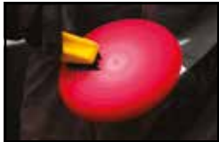
将 G Mop 高溶解泡沫垫*装到抛光机上。用清洁刷清洁新垫子。为新垫子装填产品
