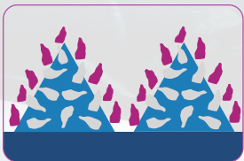
諾頓DDR砂碟工程級磨料 (多層堆積結構)
